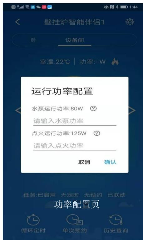
上，观察并记录功率下降稳定后的功率数值（允许误差10瓦），然后点击右上角设置键，选择【运行功率设置】，输入两个功率（数值小的是内置水泵功率）。
