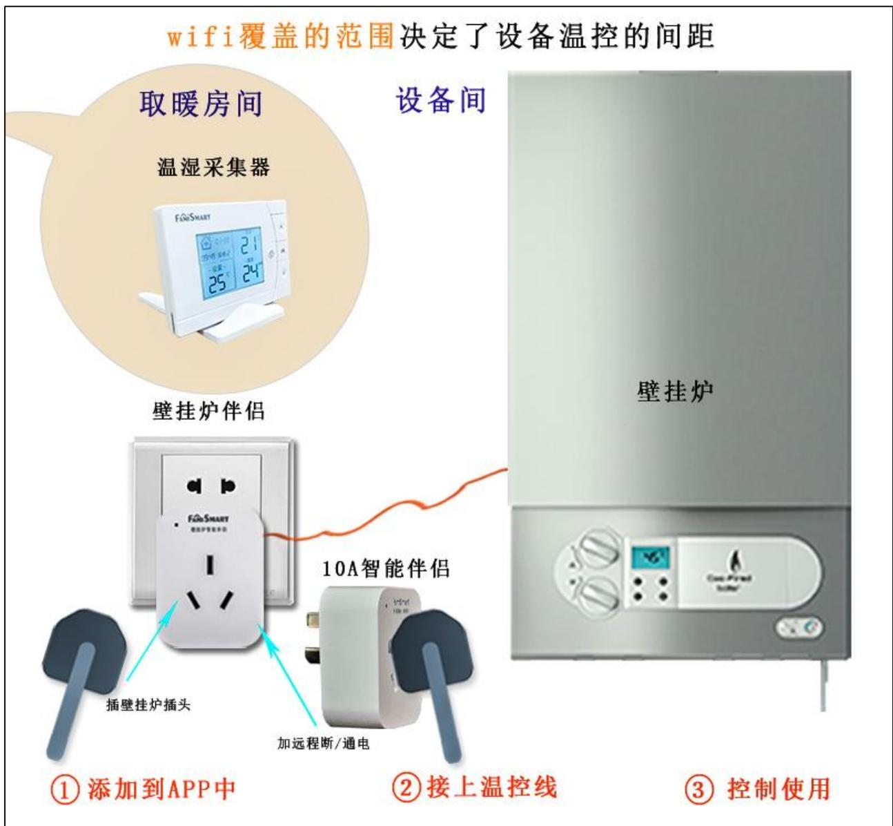
插头)，将采集设备插在取暖房间(请避开阳光直射、通风口和发热设备)。将壁挂炉水温设置在55度左右(如果地板材质允许，可以调节到壁挂炉允许的较高温度)。
