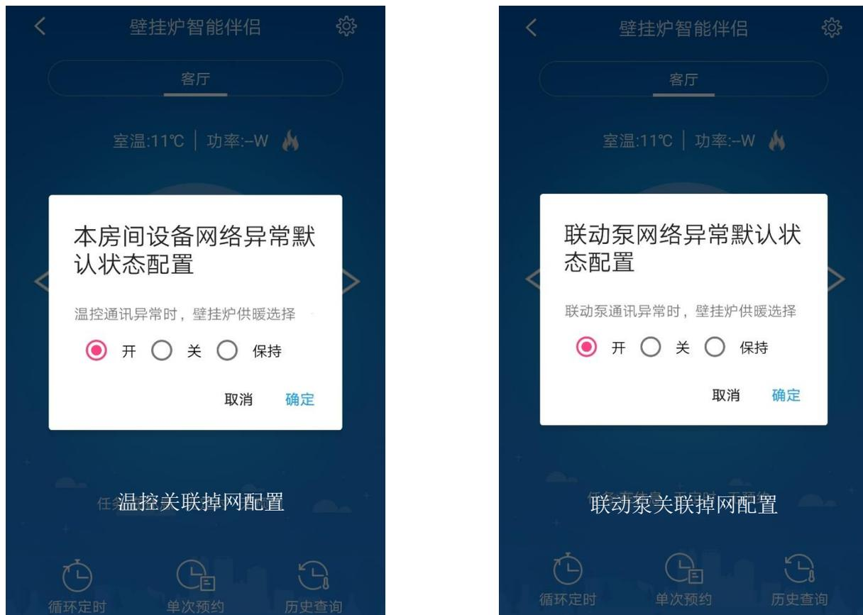
进入壁挂炉智能伴侣控制页，点击右上方设置键，进入“本房间设备网络异常时默认状态配置”，点选后“确定”。
