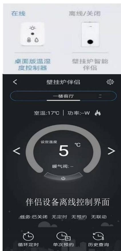
2. 只有伴侣设备掉网（指示灯亮1秒暗1秒频闪）时：壁挂炉控制页面为黑灰色，有室温显示，手机上无法进行调温控制。壁挂炉的状态会遵循“本房间设备网络异常时默认状态配置”，直到设备再次上网。
