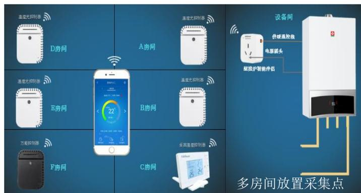
当有多个房间的采集设备与壁挂炉智能伴侣关联进行室温控制时，如果没有作分室阀门控制，请选择开启一个房间供暖开关，关闭其他房间供暖开关；如果用户选择开启多个房间供暖，壁挂炉将满足所有房间的设置温度后才能停止升温，其结果是，部分快速达到目标温度的房间，其实际温度比设置温度高。
